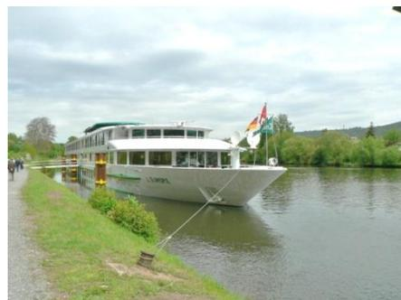
Le MS. L'Europe, en service depuis 2006, est propulsé par 4 moteurs de 600 chevaux et des moteurs latéraux. Sa vitesse peut atteindre 28 km/h dans le sens du courant et 15 à 18 km/h à contre-courant. Il consomme environ 25 000 l de carburant sur le trajet Strasbourg-Budapest.
